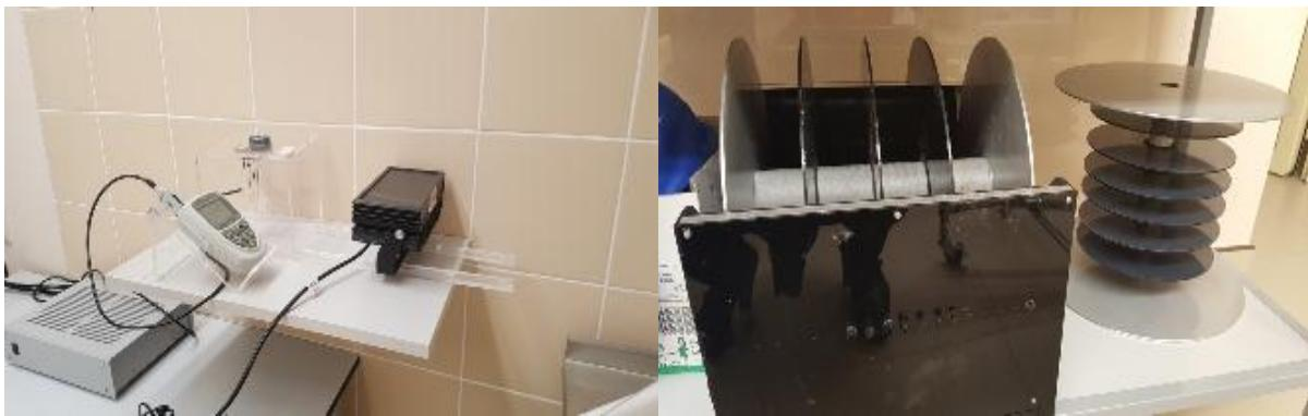
**Плетизометр – используется для исследования экспериментально вызванной воспалительной реакции у грызунов и оценки эффективности противовоспалительных препаратов. Принцип метода – изменение давления в водной камере при погружении конечностей лабораторного животного.**
