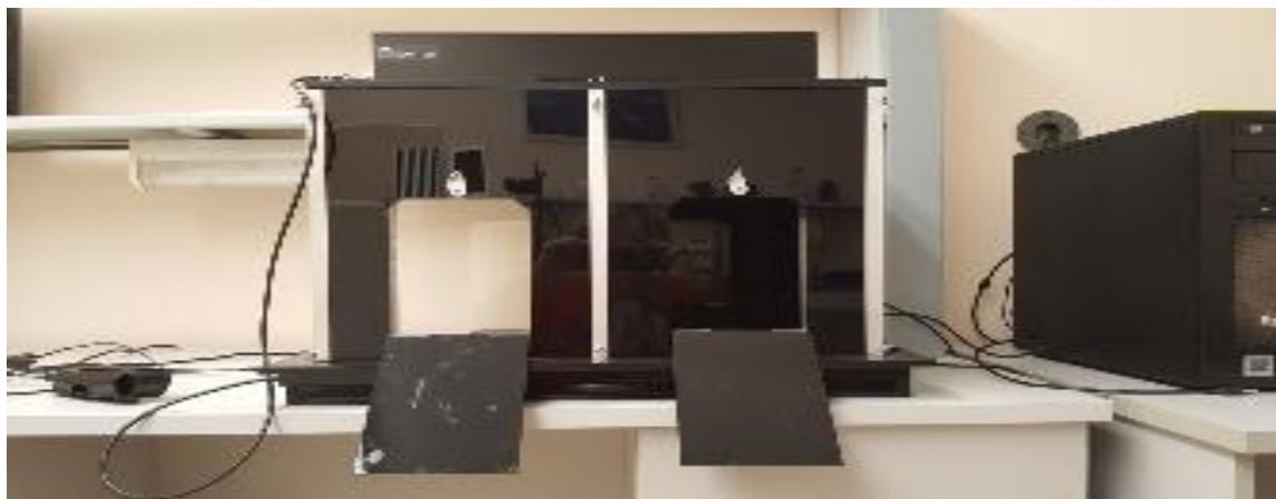
Аппаратно-программный комплекс «Шелтер» предназначен для автоматизированного определения когнитивных функций (обучаемость и память) лабораторных животных на основе реакции избегания электрокожного раздражителя. АПК позволяет проводить тестирование для мышей или крыс.
