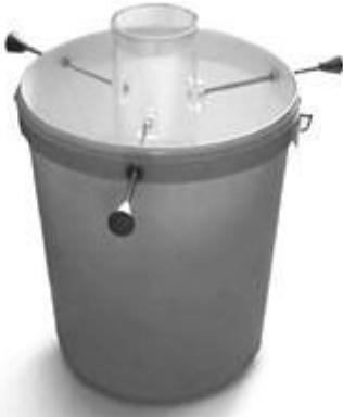
**Установка "Экстраполяционное избавление"** предназначена для изучения когнитивных функций грызунов в условиях острого стресса.
